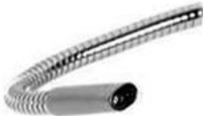
Silmaliikumis-sensor, lülitina toimivad silmaliigutused eri suunas või pilgutamine
